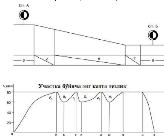
2.4 – rasm. A va B stansiyalari o'rtasida uzoq vaqt pastga tushadigan ia tarkibining harakat tezligi lentasini yozib olish namunasi
