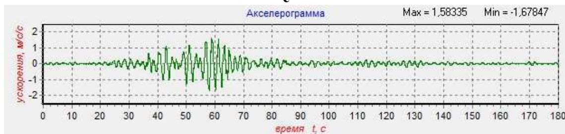
Рисунок 4. Запись реального воздействия Мехико-сити 1995 г с преобладающим периодом 2 с и PGA=1.58 м/с 2 и спектр его ускорений для коэффициентов неупругого сопротивления сверху вниз \gamma=0.05 ; \gamma=0.1 ; \gamma=0.15 и \gamma=0.2
